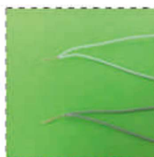
Ismételje meg a műveletet a fehér vezetékénél is. Megjegyzés: kössön egy csomót a szürke vezeték végére a polaritás megkülönböztetése érdekében.
