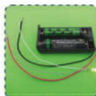
4. Vezetékek csatlakoztatása: Csatlakoztassa a piros vezetékét a fehér vezetékhez. A fekete vezetékét pedig a szürke vagy sárga vezetékhez csatlakoztassa.
