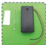
1. Szükséges anyagok és eszközök: Elemtartó, LED izzó, ragasztószalag, csavarhúzó és 2 db AAA méretű elem (a csomag nem tartalmazza).
