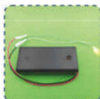
4. Vezetékek csatlakoztatása: Csatlakoztassa a piros vezetékét a fehér vezetékhez. A fekete vezetékét pedig a szürke vagy sárga vezetékhez csatlakoztassa.
