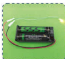
5. Szigetelés: Tekerje körbe a csupasz (kilátszó) drótokat ragasztószalaggal.
